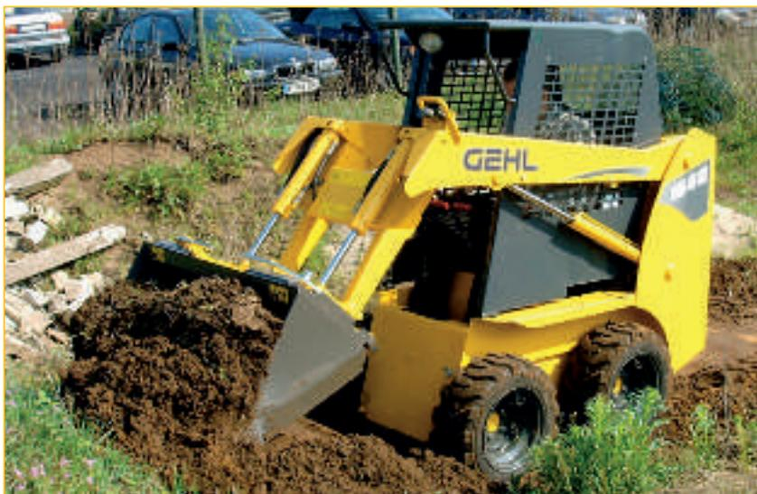
Questa piccola pala compatta fornisce all'utente lo stesso confort che ci si aspetta dai mezzi più grandi: eccellente visibilità dovuta al disegno particolare dei bracci Power-View, una guida uniforme grazie ad un passo allungato, leve di controllo confortevoli e meno faticose da manovrare, braccioli, cinture di sicurezza regolabili e arrotolabili, basso livello di rumorosità e di vibrazioni in cabina, serbatoio carburante con chiusura e pulsante di stacco batteria.
