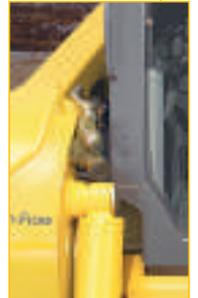
Un nuovo sportello posteriore, un coperchio motore e portello per l'impianto di raffreddamento forniscono un accesso rapido e completo al vano motore.
